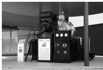
高砂熱学イノベーションセンターに保存・展示されている「高砂荏原式ターボ冷凍機」
