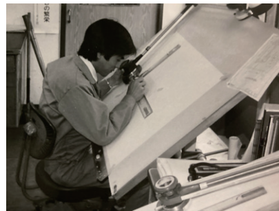
ドラフターで施工図作成中(1976年)
