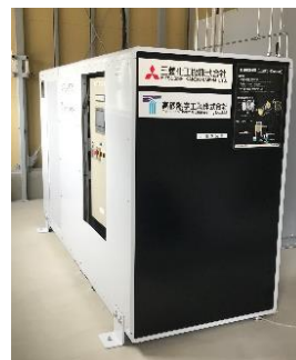
三菱化工機と共同開発した固体高分子形水電解装置
