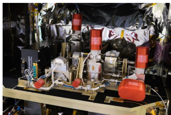
ランダーに搭載された月面用水電解装置
