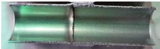
写真 11 バンドソーで切断した配管
