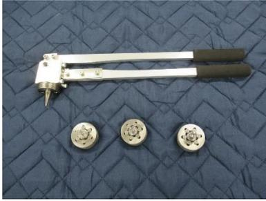
写真 15 アルミ拡管機とヘッドアダプター
