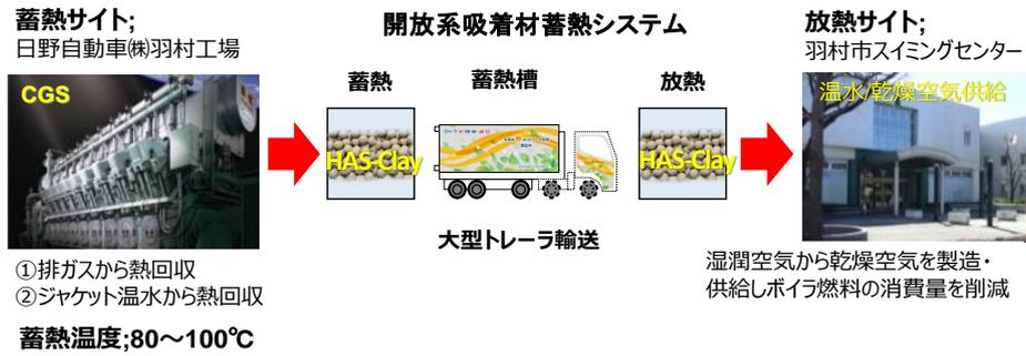
図 6 オフライン熱輸送型実証試験
