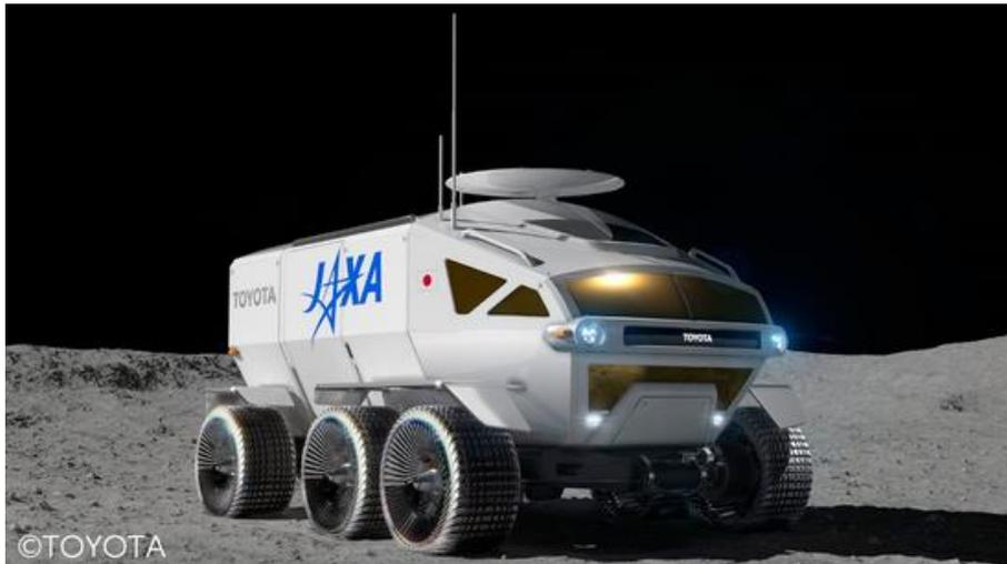
図4 有人圧ローバ“ルナ・クルーザ”のイメージ図<sup>6)</sup>
