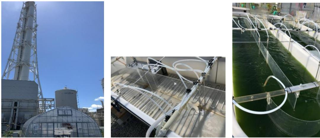
(A) 発電所の煙突とビニールハウス (B) 藻類培養池の熱交換器 (C) 藻類培養池への排ガス投入
