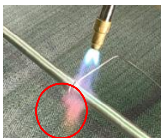
写真7 アルミ管の予熱時の火炎色の変化
