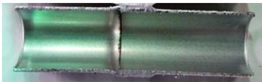
写真 11 バンドソーで切断した配管
