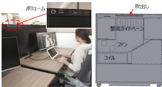
図 13 衝立型タスクデスク空調機の外観と構成
