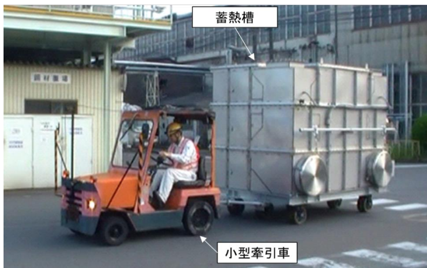
写真 1 蓄熱槽と小型牽引車
