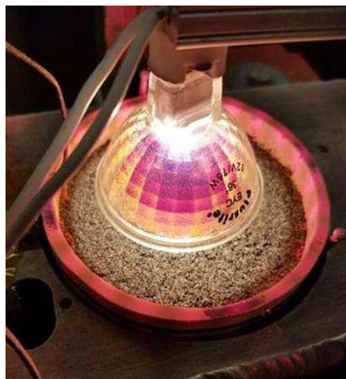
図8 模擬月面レゴリスの加熱・水採取実験(コロラド鉱山大学) 9)
