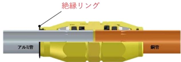
図4 アルミ機械式継手の構造
