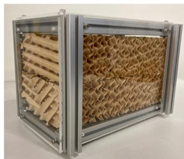
写真1 LDU 気液接触部の外観
