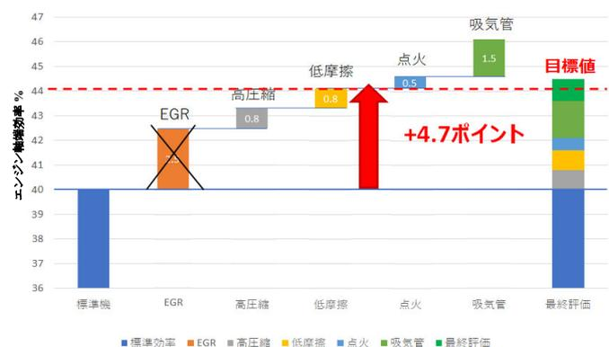
図9 エンジン軸端効率の向上
