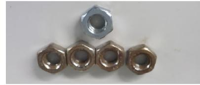
写真 3 排気 HEPA フィルタ固定ナット腐食の様子
