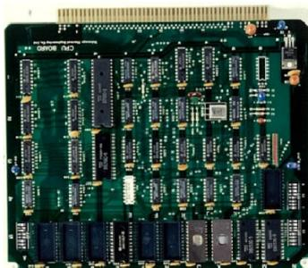
図 25 マイクロプロセッサ搭載の制御基盤<sup>27)</sup>
