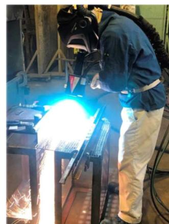
図5 開発材料の溶射施工状況
