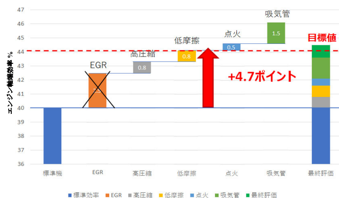
図9 エンジン軸端効率の向上
