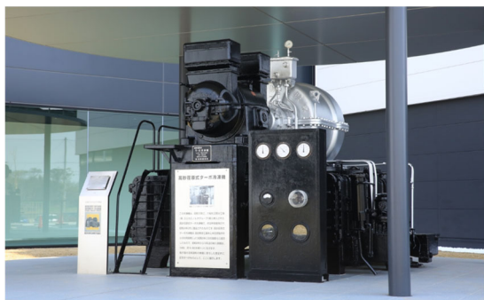
図 30 日本機械学会機械遺産第 42 号 「高砂荏原式ターボ冷凍機」 41-43)
