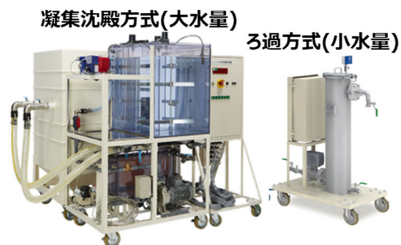
図 16 排水レスフラッシング®工法で用いる水浄化装置 10)
