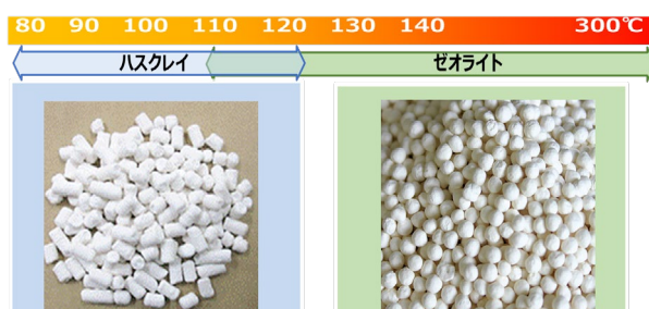
図4 吸着材の種類と使用温度帯
