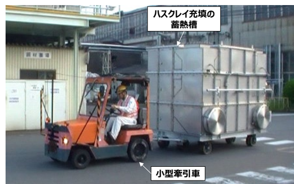
(b) 蓄熱槽と搬送用小型けん引車
