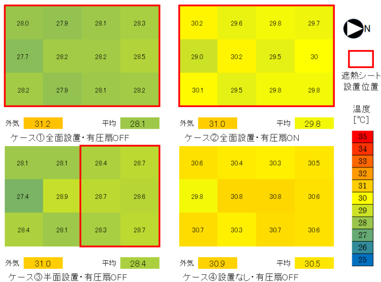
図6 各ケースの床上1.0m平面温度分布
