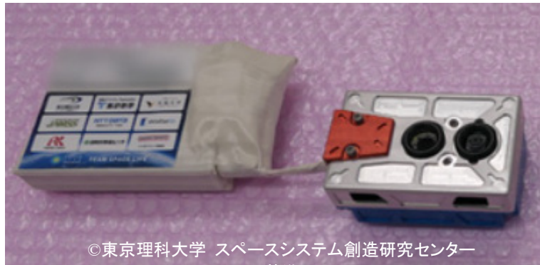
写真1 小型自律分散型環境センサー(TEM)の外観
