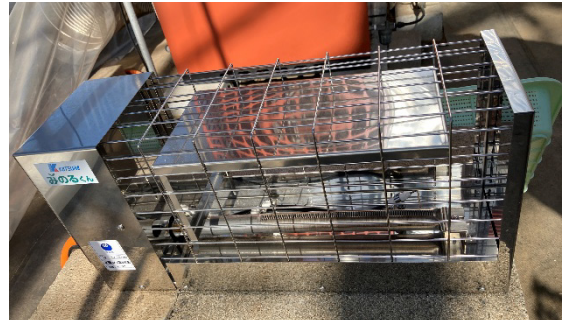
写真 2 LPG 燃焼式 CO 2 発生装置(試験区 2)
