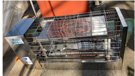
写真 2 LPG 燃焼式 CO 2 発生装置(試験区 2)
