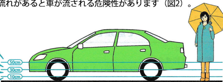
図2: 浸水深別の車の危険性について
