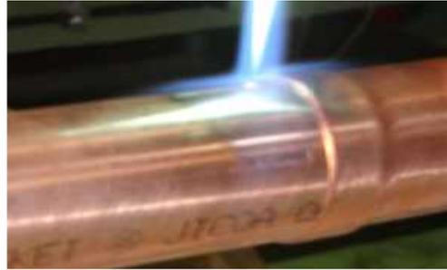
写真 2 開口部より燃焼ガスを入れる
