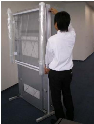
① 側面ネジを緩めてフレームを床に固定
