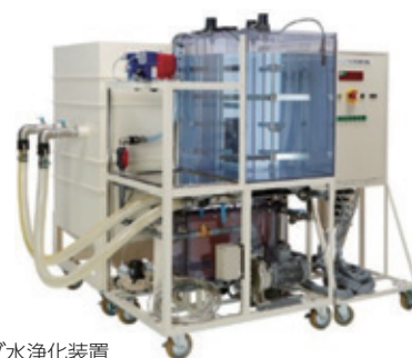
フラッシング水浄化装置
