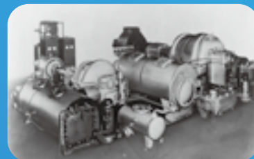
1940年 -75℃超低温装置、超低温ターボ冷凍機を 開発・納入
