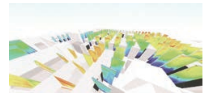
サーモカメラを使ったサーバールームの温度分析可視化例 (特許申請中)
