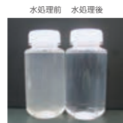
洗浄水の処理状況
