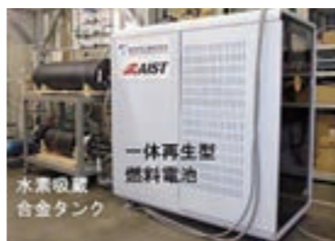
国立研究開発法人産業技術総合研究所つくばセンターに試験導入した水素利用型蓄電装置
