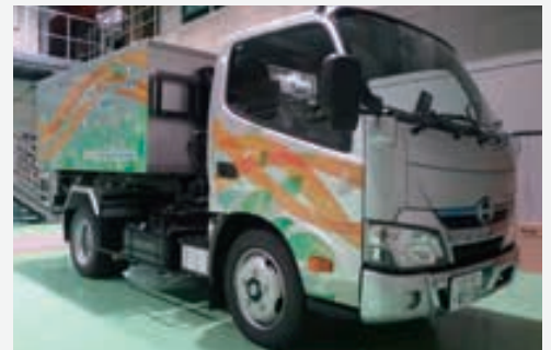
トラック搭載時蓄熱システム外観
