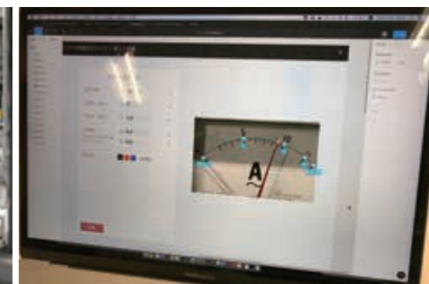
遠隔にて計器画像を確認し自動的に数値化
