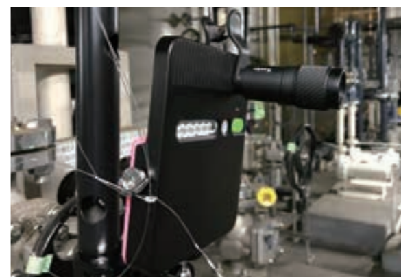
Lilz Gauge専用IoTカメラ
