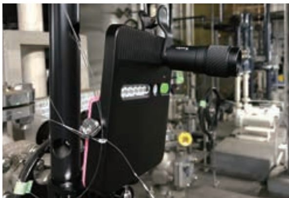
LiLz Gauge専用IoTカメラ
