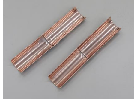
【写真3 エルブレイズ工法(酸化皮膜なし)】
