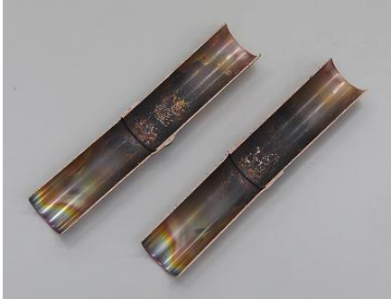
【写真2 酸化皮膜の形成状況】
