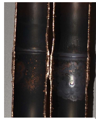
写真3-3 酸化防止なし 剥離性酸化被膜あり
