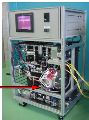
図-1 JAXA に納入した URFC 単体（左）と、URFC を用いた蓄電装置（右）
