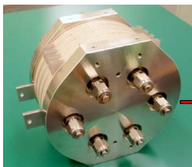
図-1 JAXA に納入した URFC 単体（左）と、URFC を用いた蓄電装置（右）
